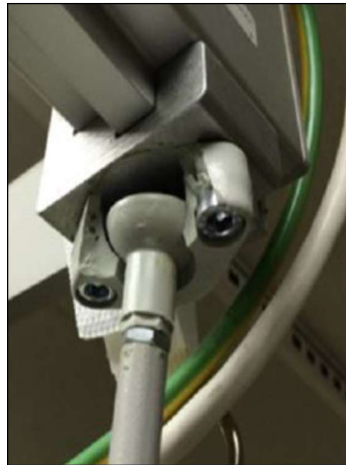
Carcasă rulment din plastic ruptă
